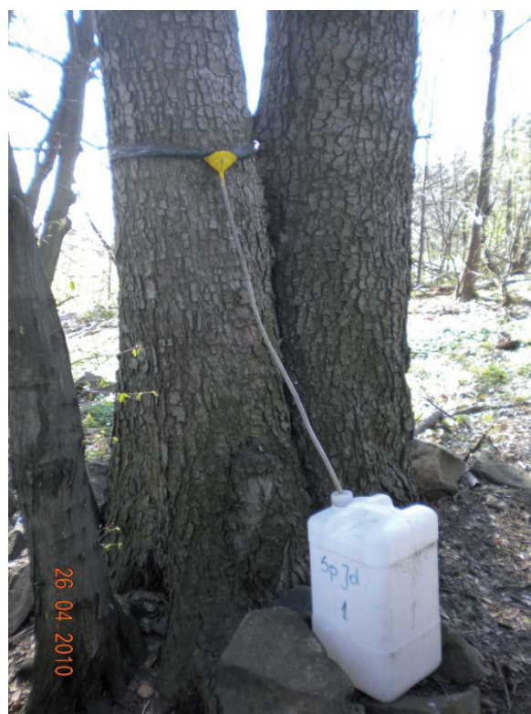
Fot. 1. Pomiar spływu po pniu jodły (fot. M. Szwed) Photo 1. Stemflow measurement of fir-tree
