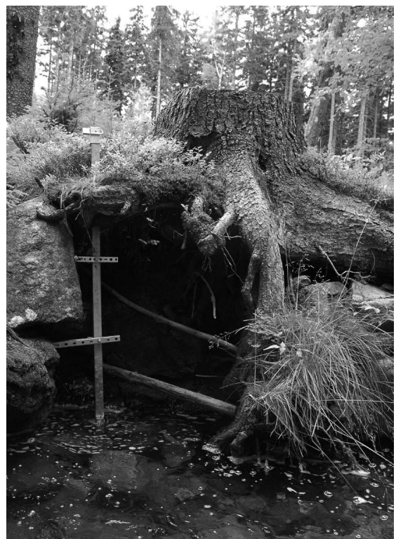
Fot. 3. Stanowisko monitorujące stan zwierciadła wody w potoku Ciekotka Photo 3. Water level of Ciekotka stream monitoring point
