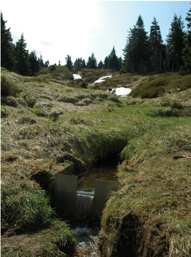
Fot. 1. Przelew prostokątny na źródle w okolicy Hali Szrenickiej Photo 1. Rectangular overfall on the spring in the Hala Szrenicka vicinity
