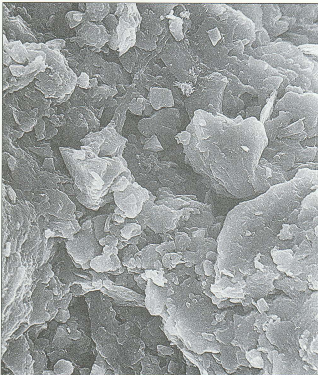
Fot. 23. Wypełnienie kawerny złączania detrytem różnoziarnistych ostrokrawędzistych łusek i mikroziarn hydrotermicznej dezintegracji (fragment fot. 14), pow. 2000x Phot. 23. Cavern of exfoliation filled with varysized detritus of sharp edged scales and micrograins of hydrothermic disintegration (fragm. of phot. 14), magn. 2000x
