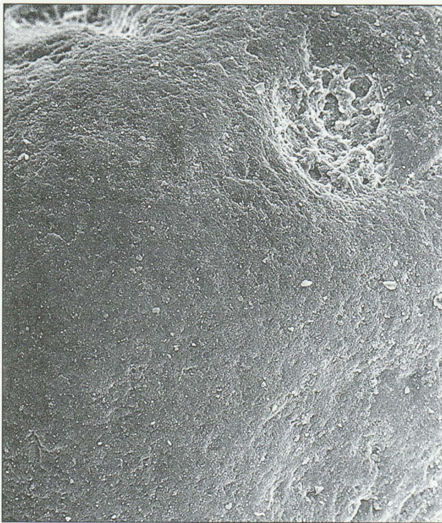
Fot. 13. Gładka powierzchnia ze starymi zaokrąglonymi kawernami zżuszczenia kriotermicznego i osadzenia chemicznego krzemianów (fragment fot. 3), pow. 200x Phot. 13. Smooth flat surface with old rounded caverns of cryothermic exfoliation and chemical sedimentation of silices (fragm. of phot. 3), magn. 200x
