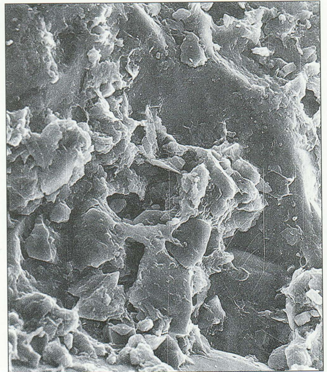
Fot. 20. Dno dużego wylamania z przełamem muszlowym, częściowo przykryte detrytem łusek scementowanych krzemianowymi wytrąceniami (fragment fot. 6), pow. 780x Phot. 20. Bottom of great conchoidal breakage, partly covered by scales detritus, cemented by siliceous precipitations (fragm. of phot. 6), magn. 780x
