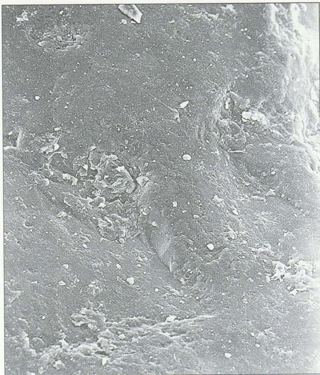
Fot. 9. Fragment gładkiej ściany ze starymi wylamaniami, krawędziami płytkich złuszczeń i sporadycznymi naskorupieniami (fragment fot. 6), pow. 300x Phot. 9. Part of smooth wall with old incisions, edges, flat exfoliation and sporadically coatings (fragm. of phot. 6), magn. 300x
